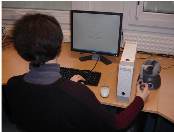
Figure 5.15 – Dispositif expérimental : l'utilisateur tient le bras haptique de sa main dominante, et interagit avec l'interface graphique avec son autre main. La boîte masque le dispositif haptique, pour éviter que le sujet observe les mouvements/oscillations du bras.
