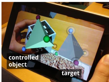
Figure 4.22 – Vue typique de l'expérience. Le tétraèdre manipulé est d'une couleur légèrement différente, pour faciliter la distinction. Le halo de tolérance sur les sommets est visible sur le tétraèdre de droite. Le marqueur lié au tétraèdre cible est visible en bas de l'image sur la tablette.
